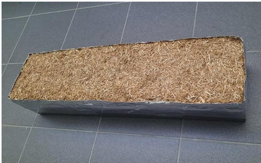
Eprouvette d'essai de l'isolant en paille hachée
