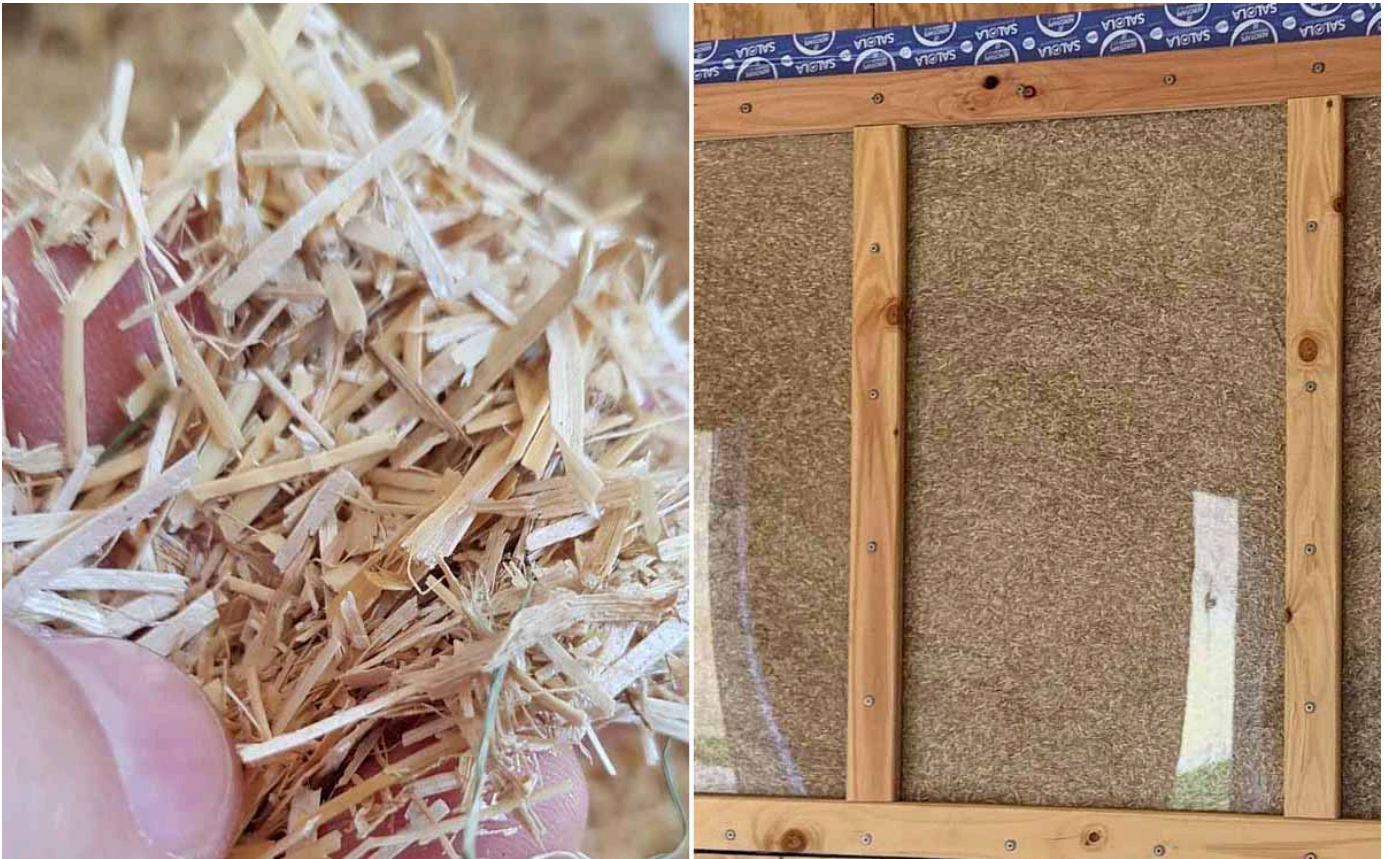
📷 La paille, une fois broyée, est insufflée dans des panneaux isolants. Crédit photo : SCIC ielo (capture d'écran vidéo Facebook)
