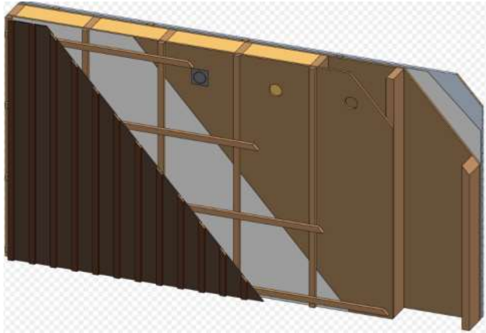
Figure 4: Principe d'insufflation derrière un panneau
