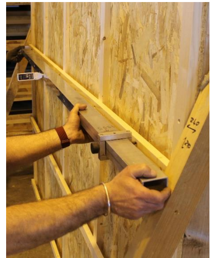
Photo 8 : Principe de mesure de planéité sur 2000mm
