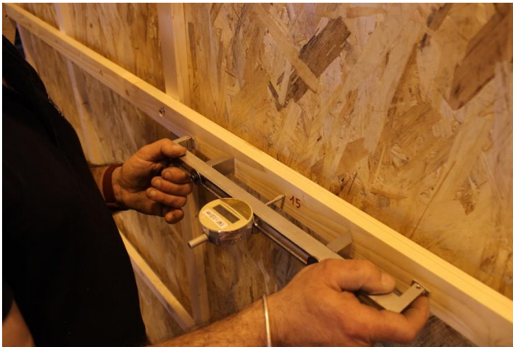
Photo 7 : Principe de mesure de planéité sur 200mm
